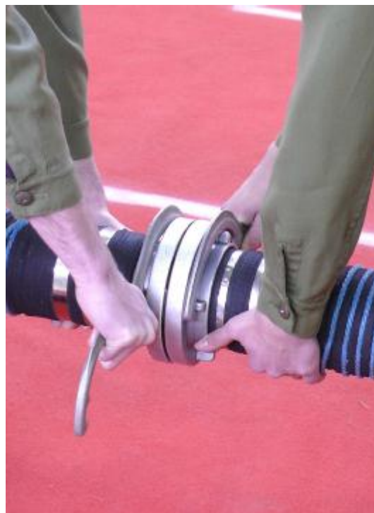
Obr. 8b: Nasazení klíčů a spojování savic
