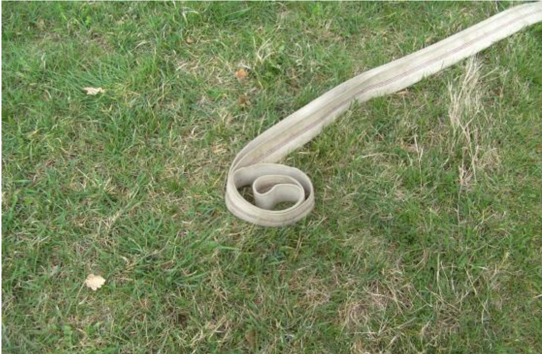
Obr. 21b: „Špatně rozložená tlaková hadice“ - „šnek“
