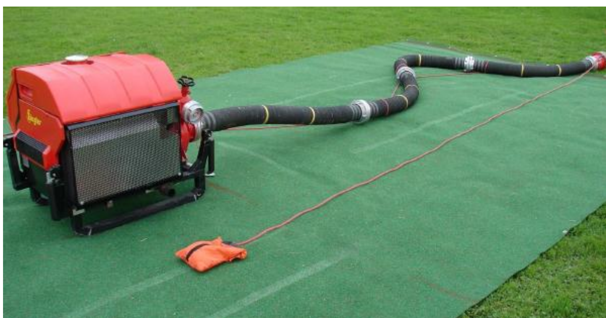
Obr. 15: Odložení vaku s ventilovým lanem
