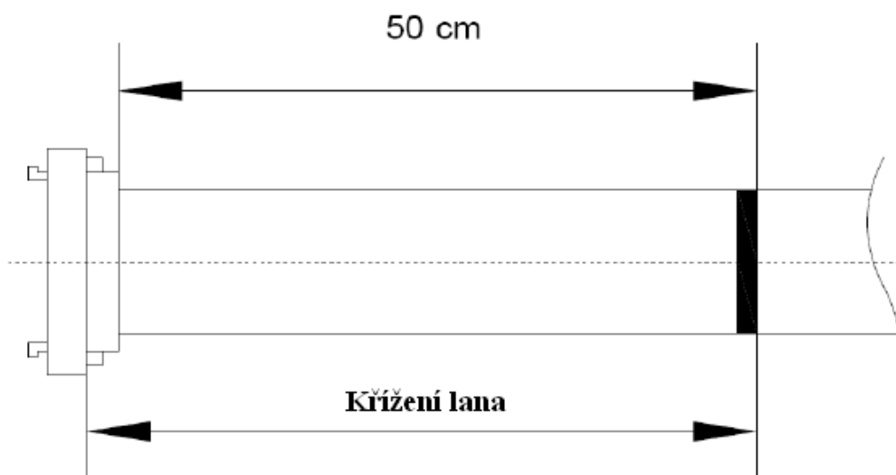
Obr. 10: Umístění značení na savici a schématické zobrazení oblasti pro překřížení lana
