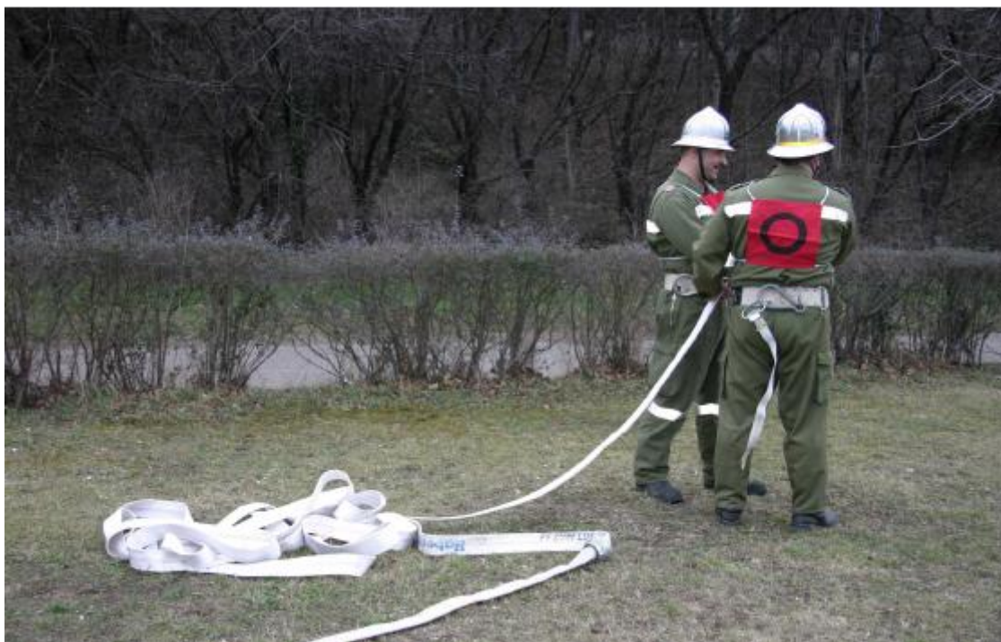
Obr. 21a: „Špatně rozložená tlaková hadice“ - „hromada“
