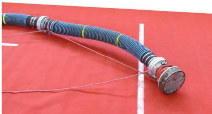
Obr. 13: Odložení sacího koše za hranici vody
