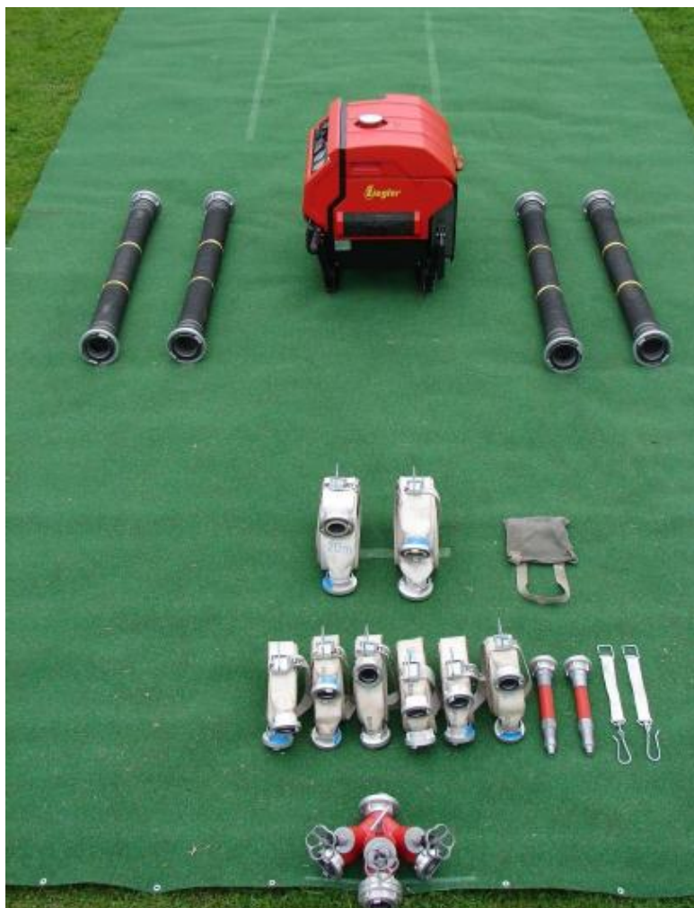
Obr. 2b: Rozložení soutěžního nářadí Na rozdělovači by neměl být přechod B/C
