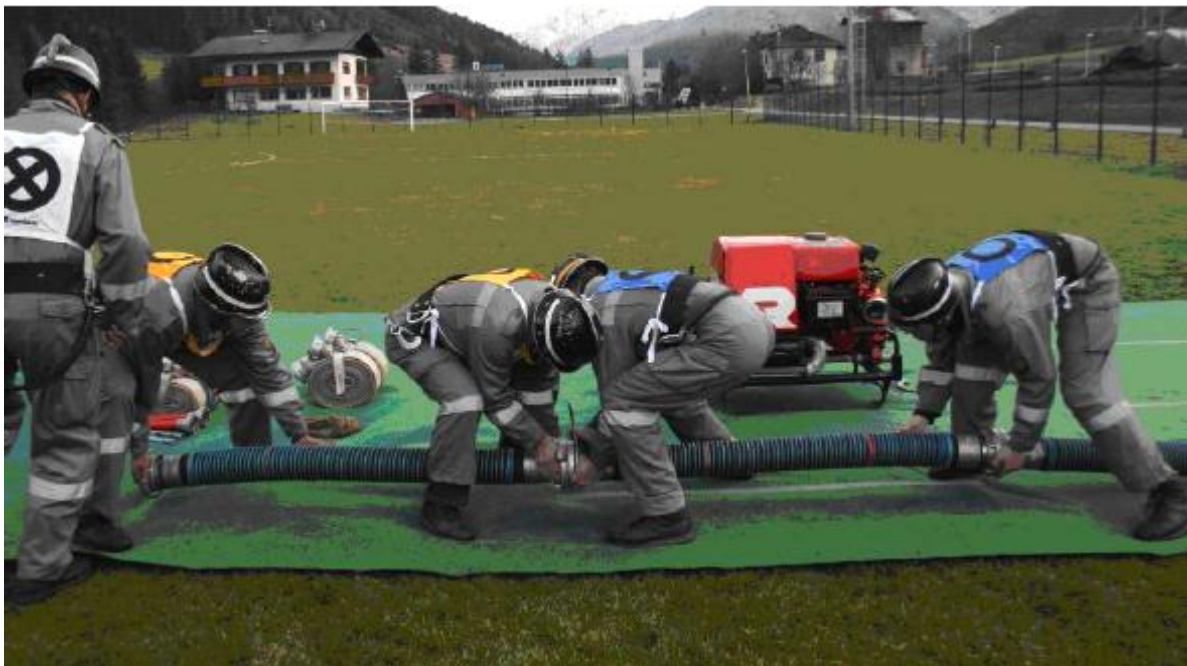
Obr. 7b: Spojování savic vodní a hadicovou skupinou
