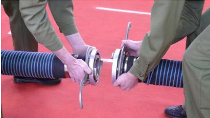
Obr. 8a: Nasazení klíčů a spojování savic
