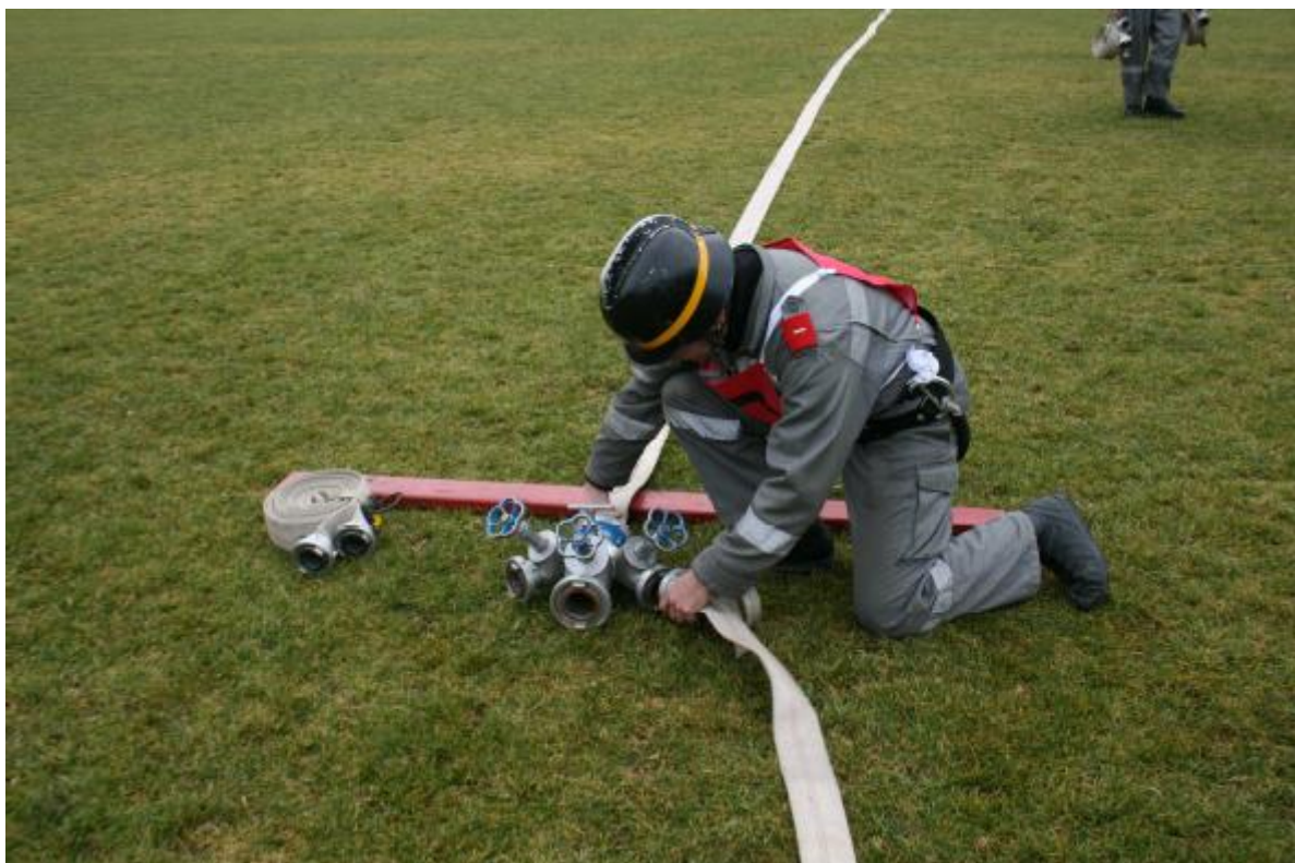
Obr. 20: Napojení hadic B a C na rozdělovač
