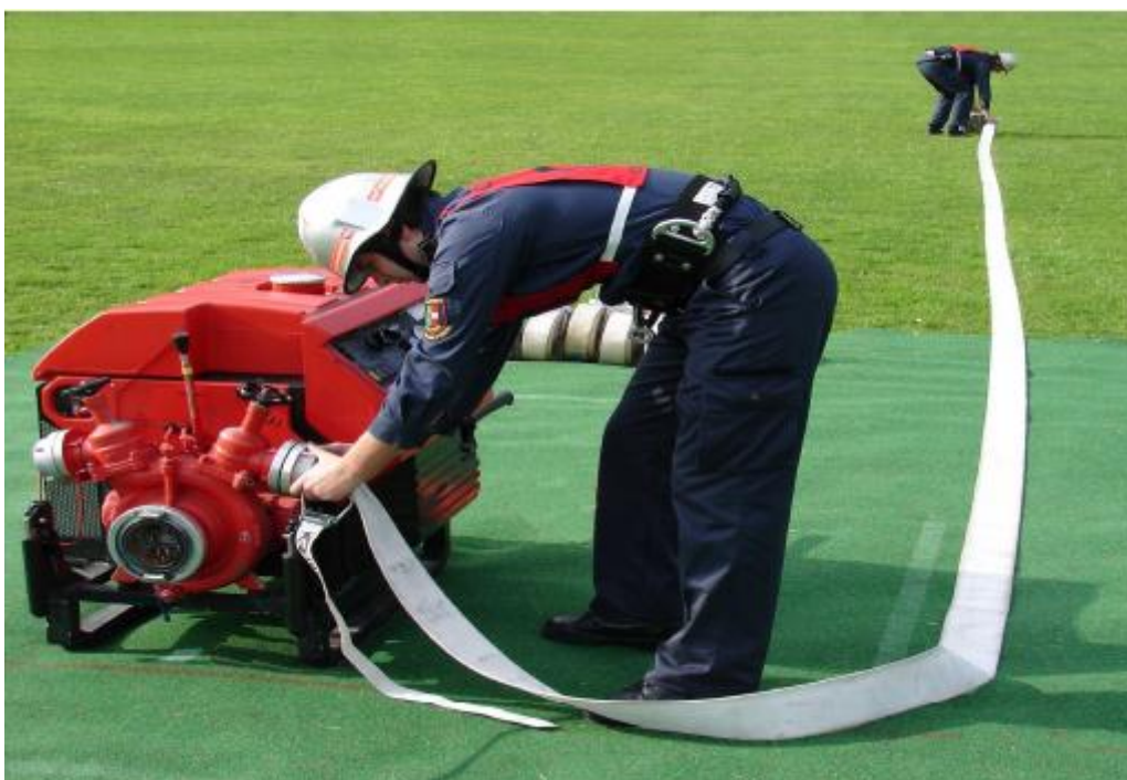
Obr. 17: Napojení a rozložení první hadice B
