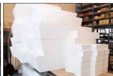
Polystyren – tajemství nepotopitelnosti hliníkových člunů MARINE s.r.o.
