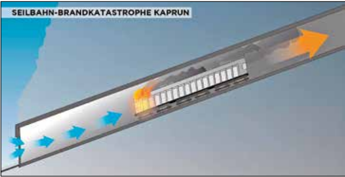
Šikmý sklon tunelu inicioval při požáru komínový efekt.
