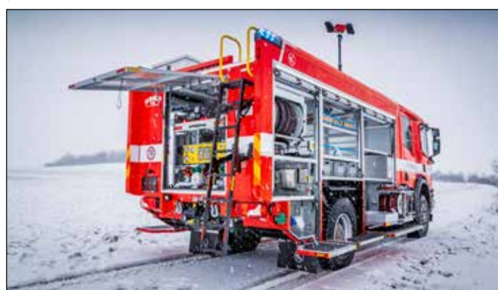
Obec Radonice v Ústeckém kraji je nyní vybavena novým zásahovým vozidlem CAS 20/4000/240 S2R na podvozku SCANIA P440. Hliníková nástavba vozidla je po celé délce opatřena výklopnými stupačkami! foto FB SDH Radonice
